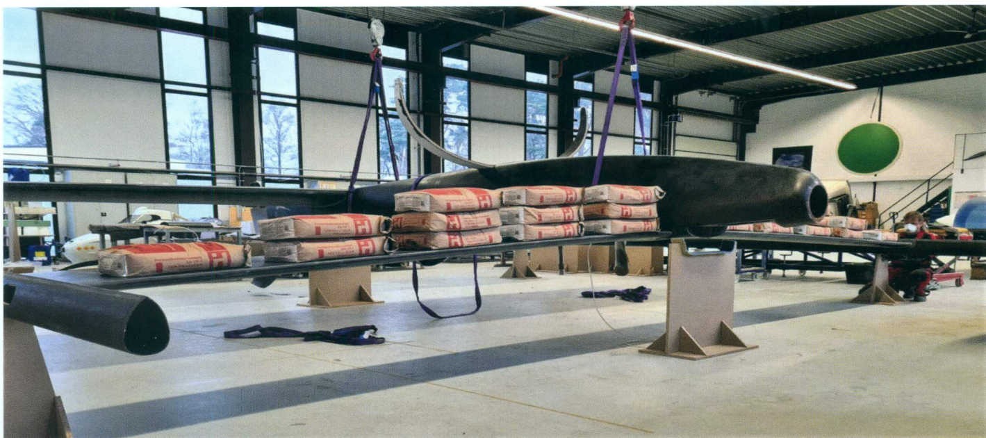
Sicherheit von Beginn an: Belastungstests der Struktur. Diese ist von Beginn an so ausgelegt, das der Flieger allen Zulassungsregeln der LTF UL entspricht.
